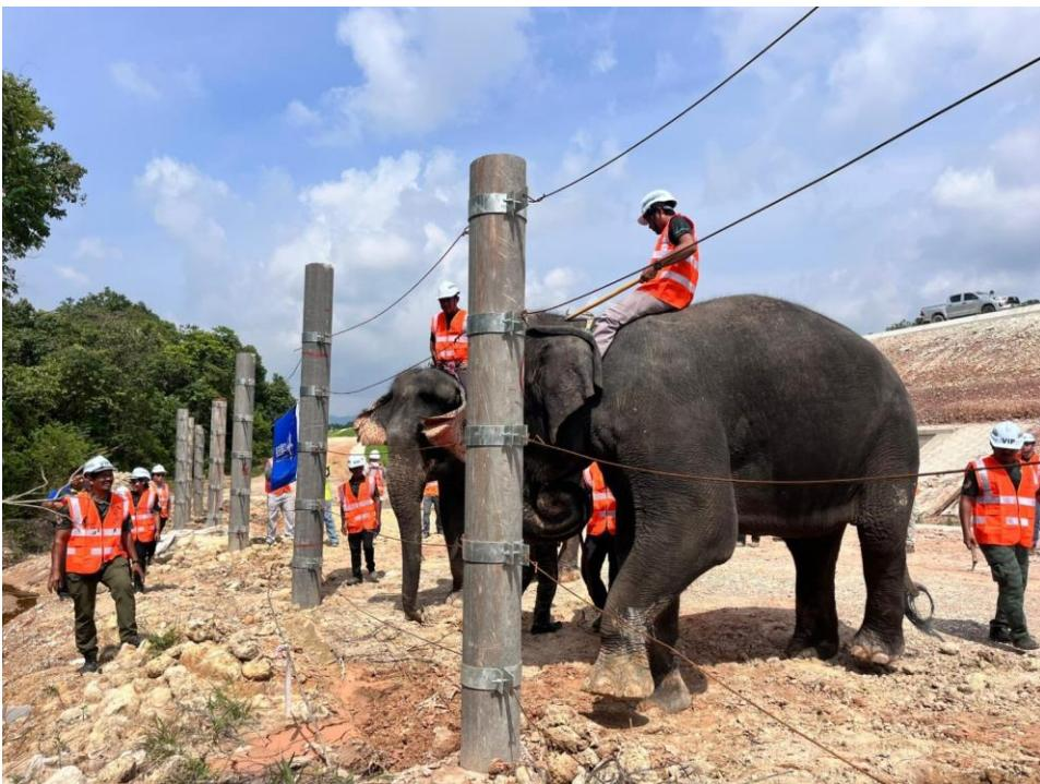
MRL dengan kerjasama Perhilitan menggunakan khidmat dua ekor gajah untuk menguji ketahanan pagar prototaip ERCL.
