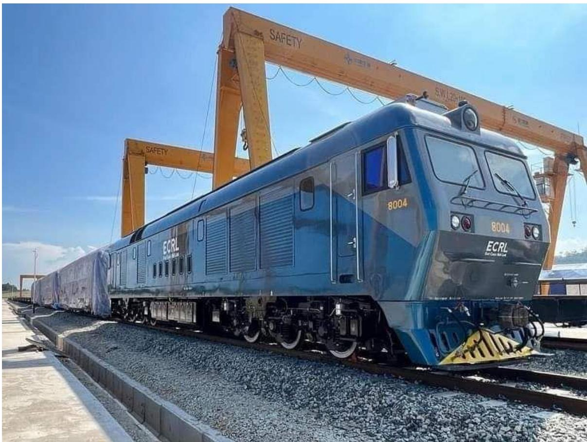
LOKOMOTIF diesel yang akan digunakan untuk kerja-kerja pemasangan landasan projek Laluan Rel Pantai Timur (ECRL).
