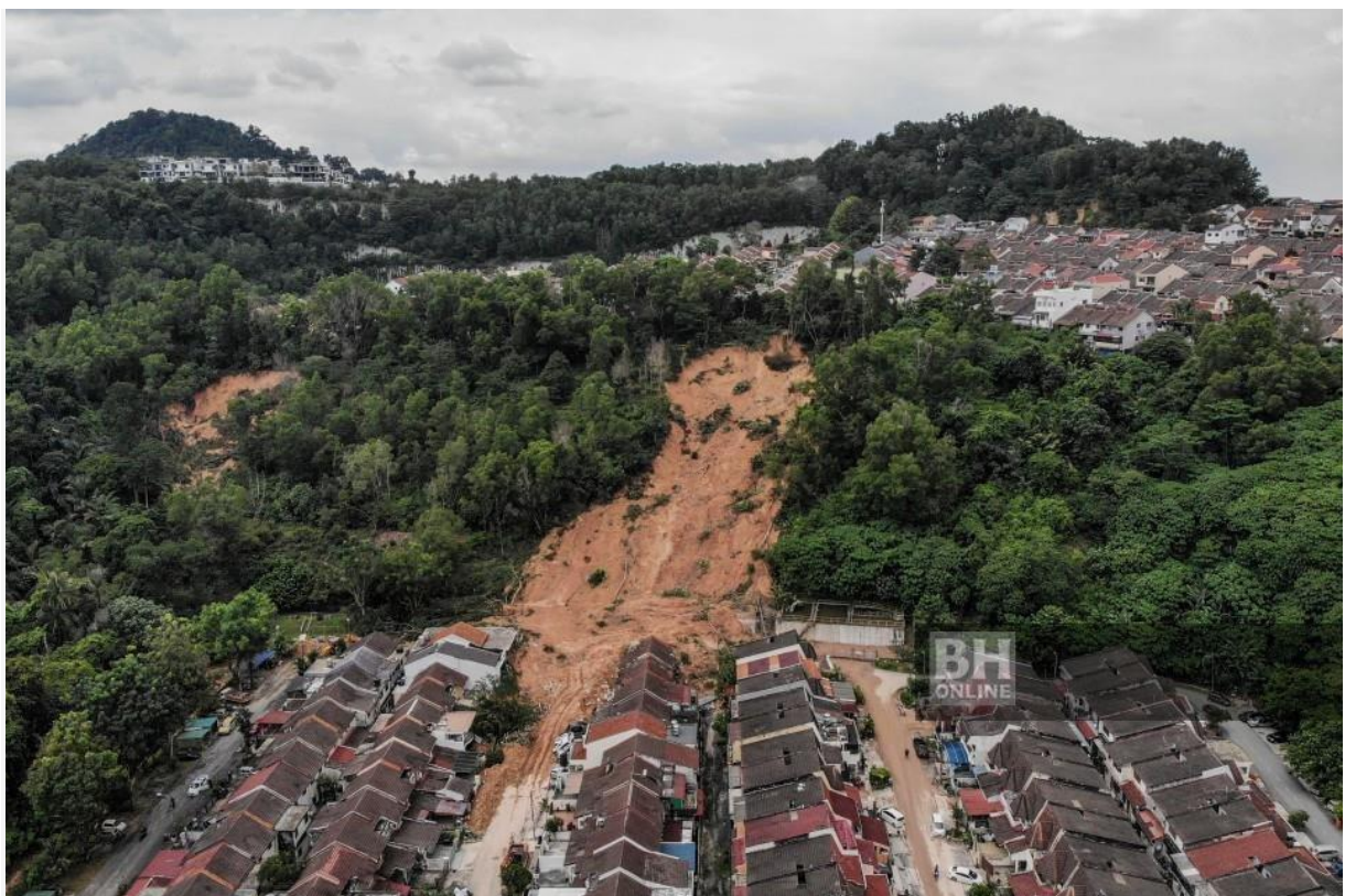
Tanah runtuh di Taman Bukit Permai 2, Ampang berlaku di kawasan bukit yang ditarah. - NSTP/AIZUDDIN SAAD
