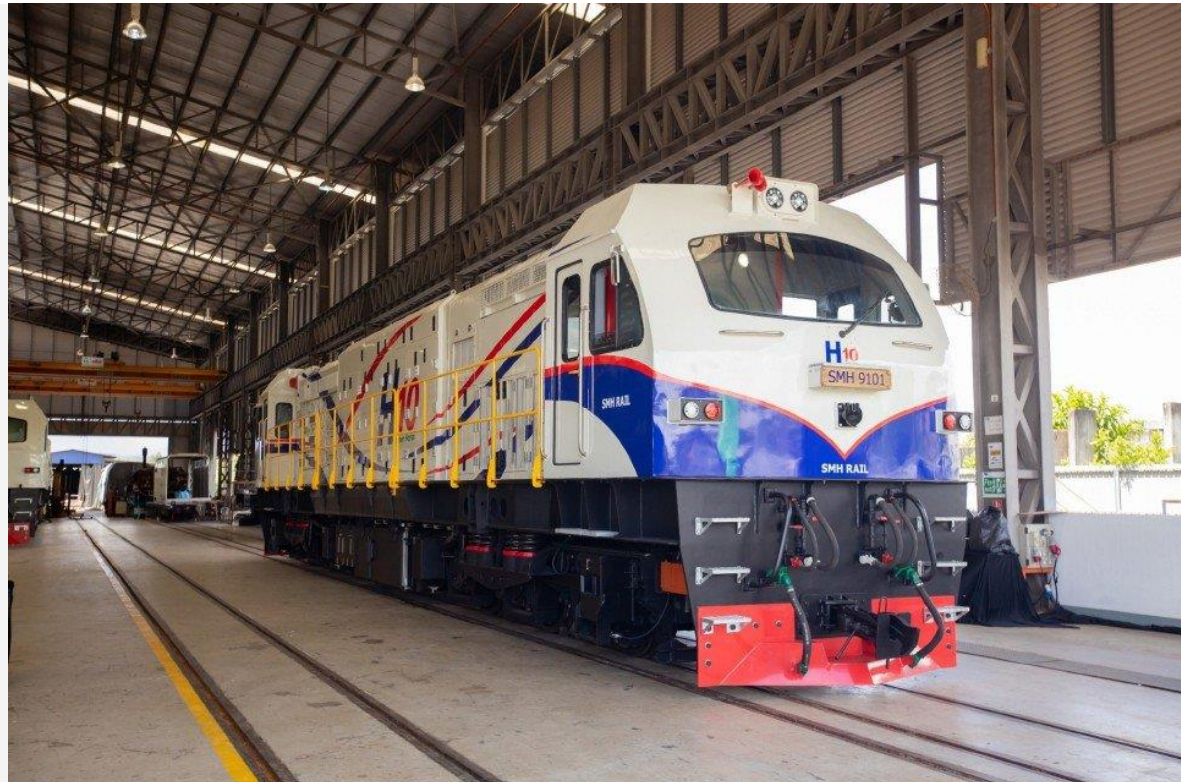
H10 Series, lokomotif elektrik diesel pertama buatan Malaysia yang direka dan dihasilkan dengan kejuruteraan tempatan oleh SMH Rail
